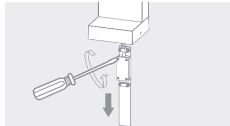
**PASSO 4.** Em seguida, realize a emenda dos fios da luminária com os da rede elétrica, atentando-se para sua posição (fase e neutro).
