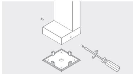
**PASSO 2.** Em seguida, utilizando os parafusos e as buchas que acompanham o produto, fixe a base no local desejado, passando o cabo da rede elétrica pelo orifício central.
