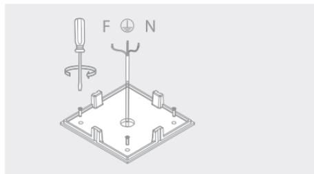
**PASSO 3.** Puxe a alimentação da luminária para fora e remova os parafusos que protegem o conector.
