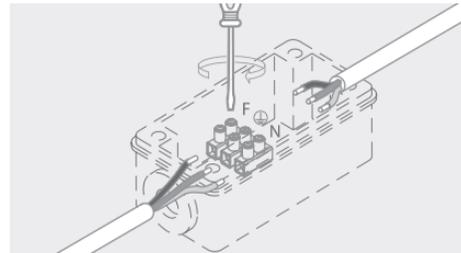
**PASSO 5.** Parafuse a capa protetora do conector novamente e empurre o conjunto para dentro da luminária, a fim de que fique o mais afastada do solo.
