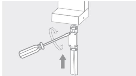
**PASSO 6.** Finalize encaixando a luminária na base e apertando os parafusos laterais.
